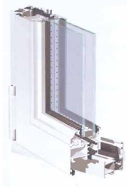
Diese Serie wurde entworfen als Ergaenzung des Systems fuer diejenige Kundschaft, die traditionell komplanare Tueren bevorzugt. Die Technologie der Standfestigkeit und thermische Isolierung der Basis-Serie wird strikte beibehalten. Es werden di gleichen Profile mit thermischer Trennung und mittige Dichtung fuer die Fuge eingesetzt.
